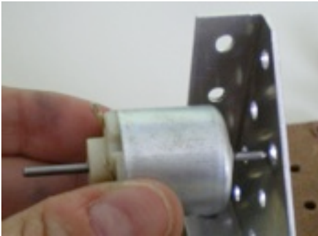
Figura 4. Colocación del motor en la primera escuadra
