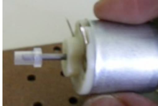
Figura 5. Montaje del casquillo plástico
